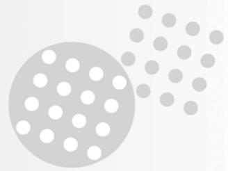
基板取り付け 穴あけパターン (ピンインシュレータの後側から見た図、半田付け側)
