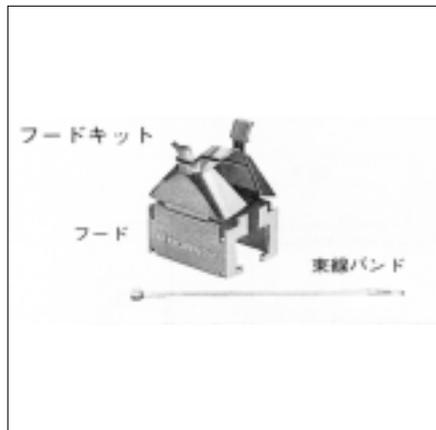
「パネルマウント」用の66ナイロンケーブルクランプで、プラグのハウジングに取り付けます。束線バンドを用いて、多少のたるみを持たせながら電線をクランプ部に固定します。これにより、コンタクト装着部にかかる張力を軽減することができます。
